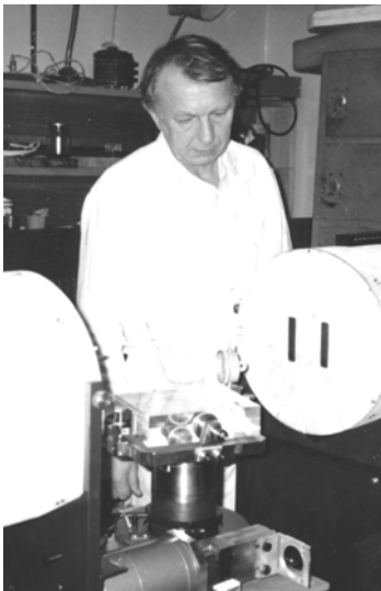
Е.Г. Лапин за установкой ДЭДМ. На переднем плане большой кварцевый кристалл, в котором напряженность электрического поля, действующего на нейтрон, достигает 200 тысяч киловольт на см
