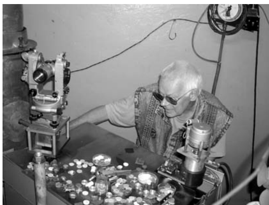
В.А. Шабуров за работой на спектрометре ГСК-4, который используется для исследования фазовых переходов
