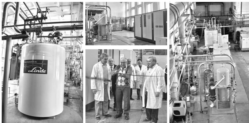
Рис. 13. Первый этап работ для нового источника УХН на реакторе ВВР-М (запуск рефрижератора на 20 К)
