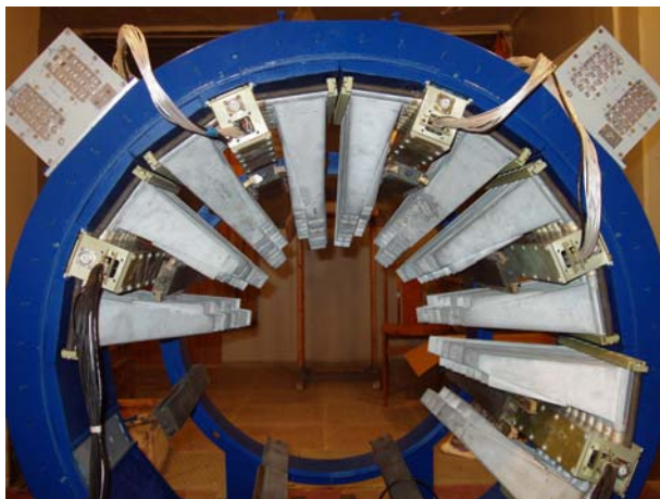
Рис.1. Кольцевой детектор с коллиматорами. Вид вдоль оси детекторной системы.
