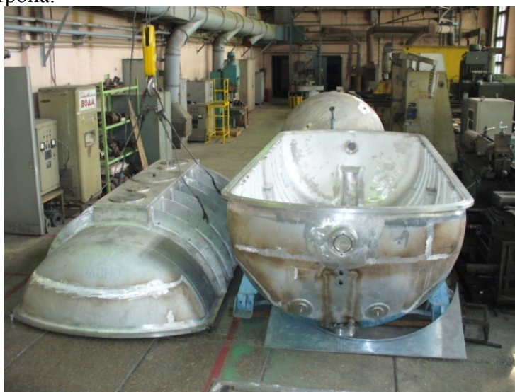
Рис.1. Вакуумная камера новой установки для измерения времени жизни нейтрона в помещении цеха экспериментального и технологического оборудования ПИЯФ.
